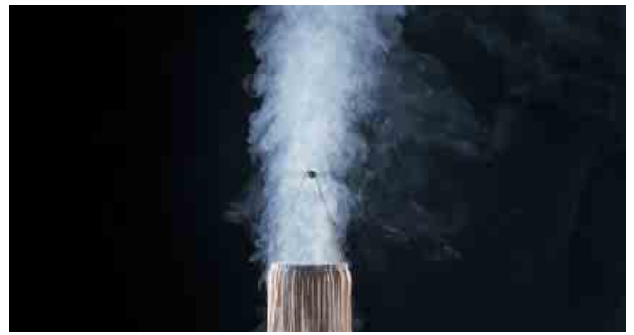
Požarna proba 3: plamteći tinjajući požar (pamuk)
