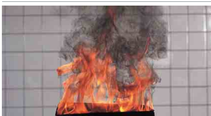
Požarna proba 5: požar tekućine (n-heptan)
