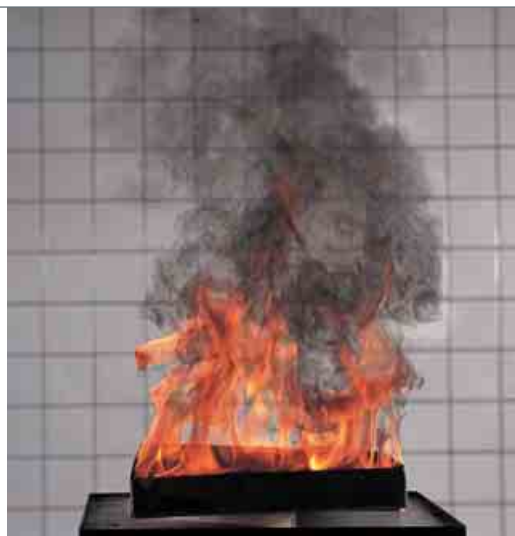
Požarna proba: n-heptan
